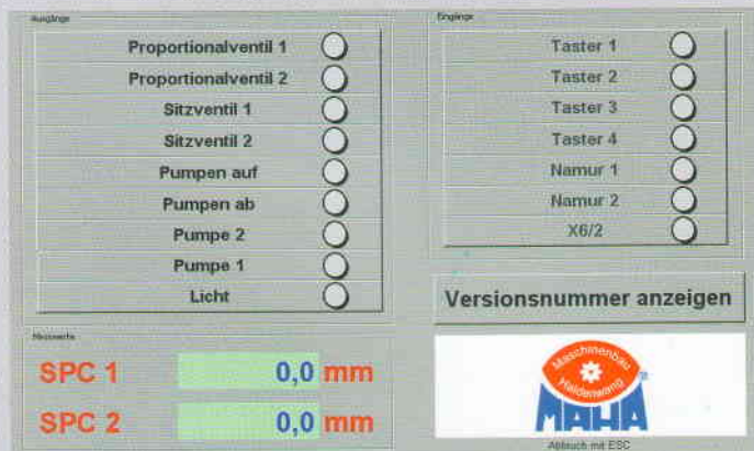
Интегрированный PC интерфейс для считывания кодов ошибок, также возможно удаленное диагностирование
